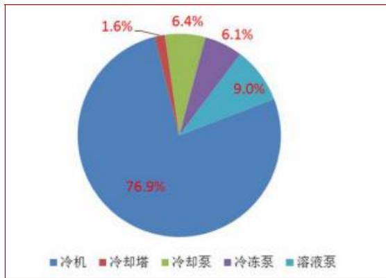
图5 夏季典型日制冷站电耗拆分图
