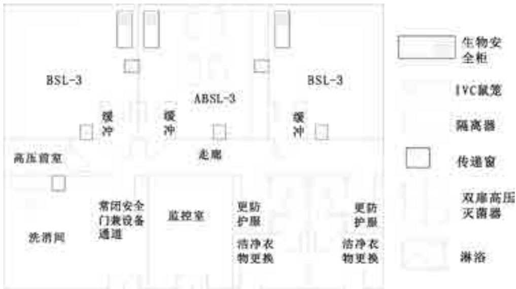
图3 某 ABSL-3 实验室多个核心工作间共用辅助用房的布局方案图
